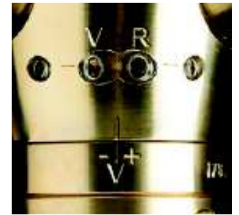
Markierungen eines LH Propellers
